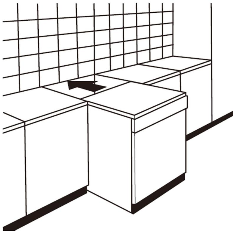
2. Выровняйте положение посудомоечной машины с помощью регулировочных ножек. Задние ножки машины могут быть выровнены с помощью регулировочного винта (рис.2)
