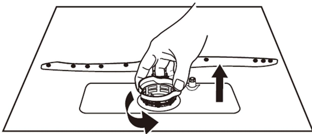
6. Произведя очистку фильтров, соберите систему фильтров и установите в посудомоечную машину, следуя приведенной инструкции в обратном порядке. Установив систему фильтров на место, закрутите фильтр крупных загрязнений, повернув его по часовой стрелке.
