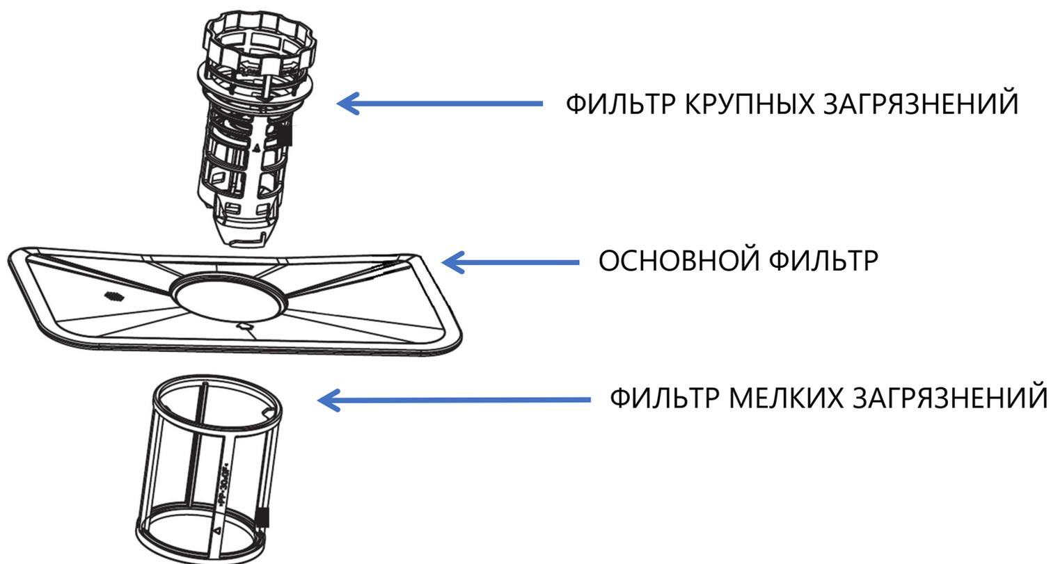
Фильтрующая система состоит из следующих компонентов:
