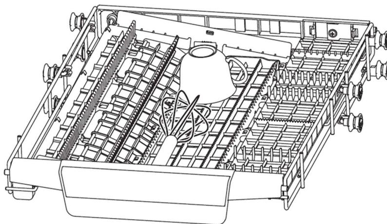
Для размещения более крупной посуды или приборов корзину можно отрегулировать по глубине. Для этого отсоедините два крепежа (указаны на рисунке) и осторожно надавите на центр секции, чтобы опустить её вниз.
