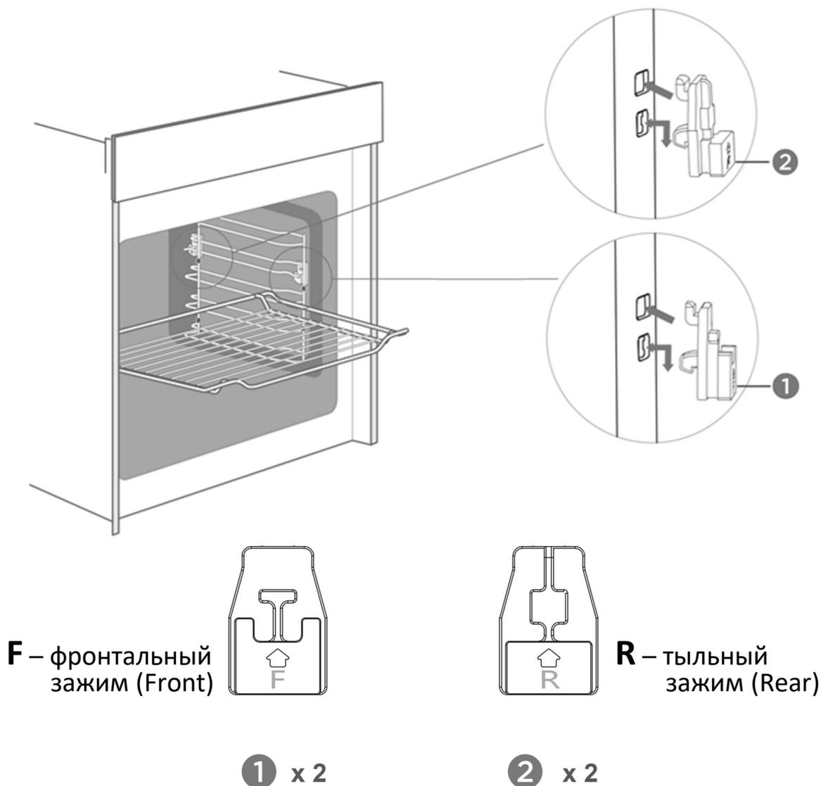
Установите керамические зажимы в боковые стенки прибора, по два с каждой стороны, как показано на рисунках. Направляющие устанавливаются в данные зажимы. Установите все идущие в комплекте компоненты и заглушки, предотвращающие касание металлических аксессуаров со стенками прибора, чтобы предотвратить искрение при их использовании в режиме микроволн.
