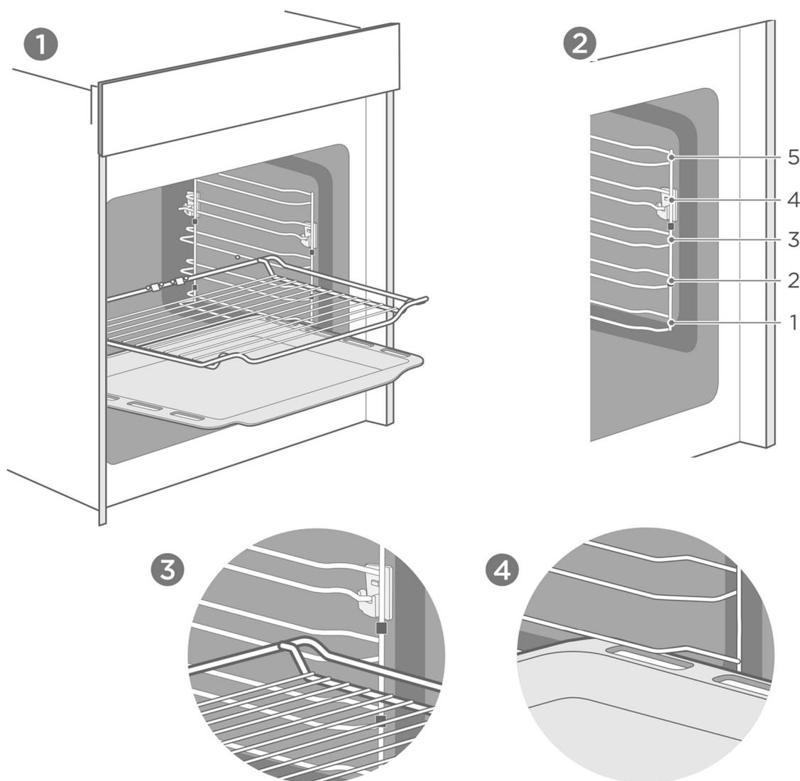
Аксессуары можно выдвигать примерно наполовину до момента их фиксации. Данная блокировка предотвращает выпадение аксессуаров при их извлечении. Чтобы защита работала надлежащим образом, решётки и противни должны быть вставлены в камеру правильной стороной.
