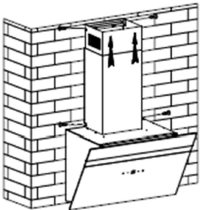
8. Выдвиньте внутреннюю часть короба на высоту саморезов, подвесьте короб на саморезы за фиксирующую скобу. По отверстиям скобы отметьте и просверлите 2 отверстия диаметром 8 мм и глубиной 75~85 мм. Далее выровняйте фиксирующую скобу с отверстиями и затяните саморезами 5x60 мм.
