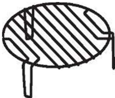
Решётка для гриля (используется в моделях только с гриль-функцией и должна размещаться на поворотном столе).
